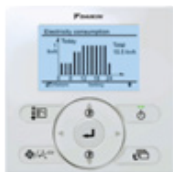
Графический дисплей с отображением ориентировочного электропотребления (Функция предусмотрена в сочетании с FBQ-D, FCQG и FCGHQ)
